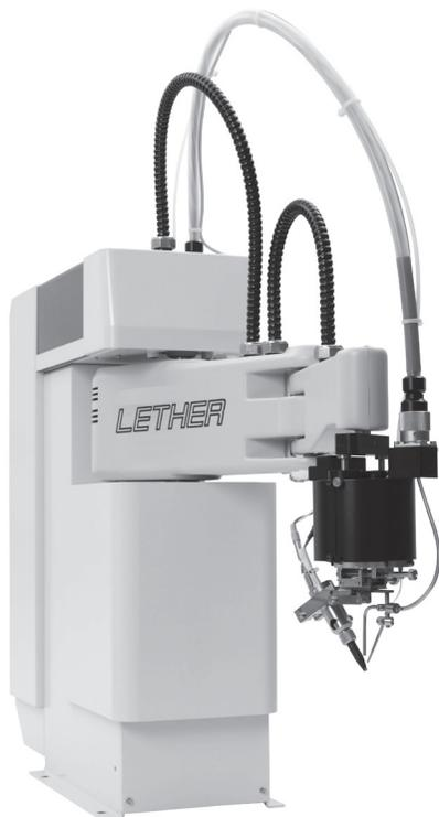
写真1 LEATHER-α(メイコー製はんだ付けロボット)
