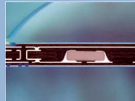
部品内蔵基板 (断面写真)
