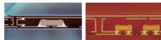
【量産品】はんだ接続部品内蔵基板 【開発品】めっき接続部品内蔵基板
