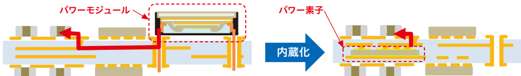
(効果) 低インダクタンス化・低ノイズ化(パワー素子SW性能向上) パワーモジュールのワイヤーボンディングレス化(低抵抗接続)
